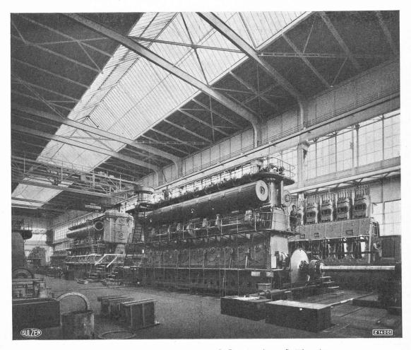
Fig. 2. — Hall de montage de moteurs *Diesel-Sulzer*, de grande puissance, à Winterthur, en 1937. Au premier plan: 3 moteurs marins à 2 temps, 10 cylindres de 6750 ch. eff., chacun, destinés à des paquebots britanniques.
