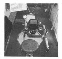
Fig. 3. — Chambre Wild sur son dispositif de suspension.
