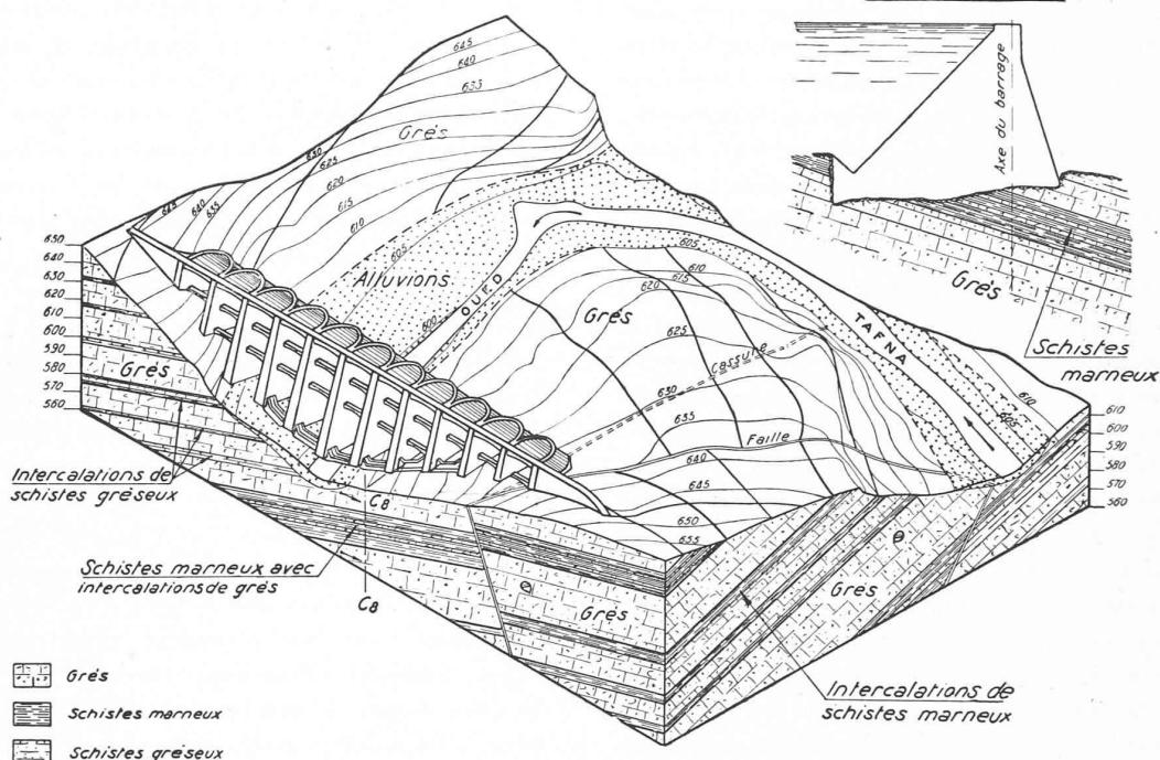
Fig. 1. — Stéréogramme géologique du barrage des Beni-Bahdel près Tlemcen, Algérie. (Dessin d'Alf. Fallonnier, géologue). — Les alternances de grès et de schistes plongent à la fois vers l'aval et vers la rive droite. Prédominance des grès sur la rive droite, failles sur la rive gauche. Faible épaisseur d'alluvions sous la Tafna.
