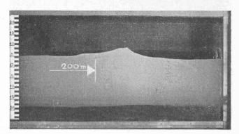
Fig. 22 et 23. — Photographies d'une des vagues du large et d'une des oscillations côté port, prises lors d'une expérience semblable à celle de la fig. 20 ci-dessus. Sur le brise-lames le déferlement partiel était analogue à celui de la fig. 6 de ce mémoire.
