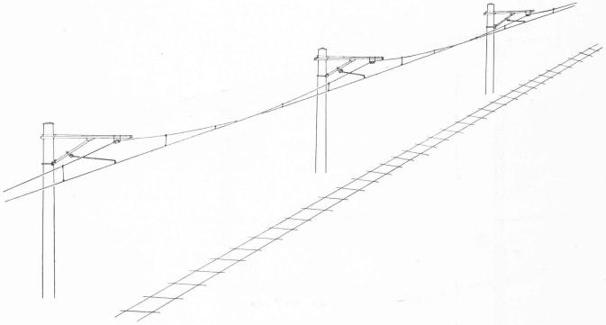
Fig. 5. — Représentation schématique de la ligne de contact.
