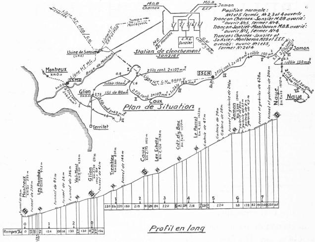
Fig. 1. — Chemin de fer Glion-Naye. Plan de situation et profil en long.
