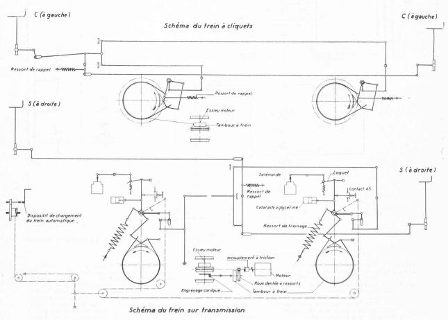
Fig. 14. — Schéma simplifié des freins de l'autorail.
