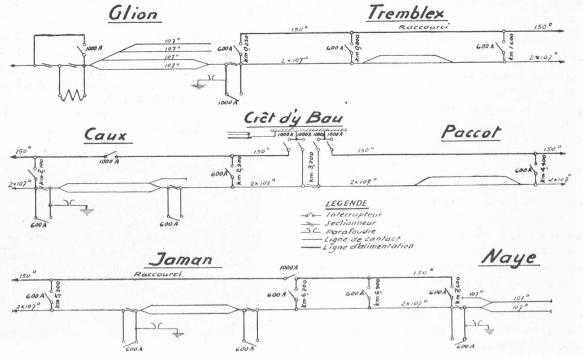
Fig. 3. — Schéma des lignes de contact et d'alimentation.
