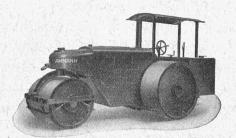
Rouleaux-compresseurs trijante Diesel 3-14 tonnes
