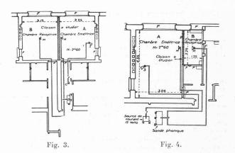
La source était disposée, comme l'indiquent les figures 3 et 4, au voisinage du mur opposé à la cloison étudiée, mais sans le toucher et à une hauteur de 1,20 m environ au-dessus du plancher. Près de la cloison à étudier était disposé, à la même hauteur, un premier microphone  $M_1$  de la sonde phonique.
