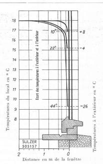
Fig. 3. Chauffage par rayonnement. Températures mesurées à 1,50 m au-dessus du sol, dans un plan horizontal et dans le voisinage des fenêtres à vitrage double, en fonction de différentes températures à l'extérieur.
