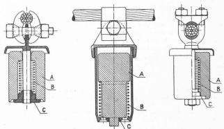
Fig. 5. — Trois exemples d'exécution d'amortisseurs à ressort.
