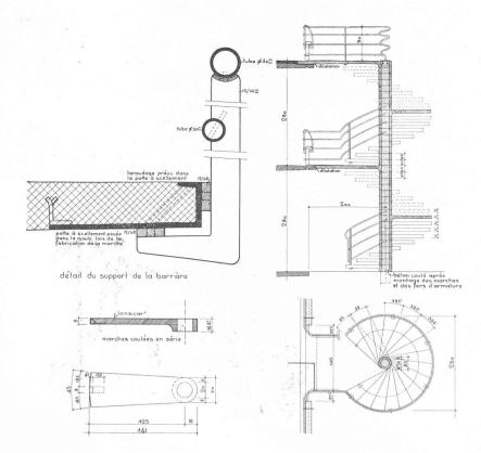
Fig. 15. — Détail de l'escalier du solarium.
