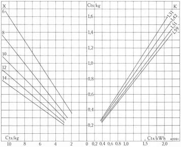
Fig. 6. — Prix de revient de la vapeur, en fonction du prix du combustible, pour différents « cœfficients de vaporisation », et du prix du kWh, pour différentes quantités de vapeur produites par kWh.
