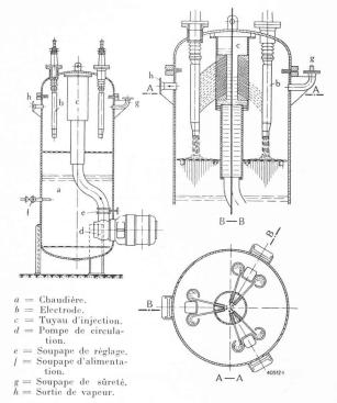
Fig. 2. — Chaudière électrique, système Brown Boveri.
