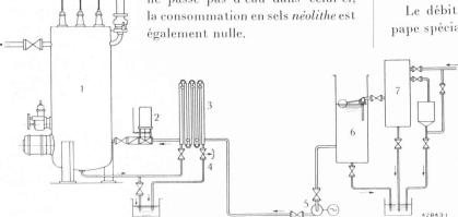
Fig. 3. — Fédération laitière du Léman, à Vevey. Installation d'une chaudière électrique, 800 kW, 4000 V, 8 kg/cm² de pression absolue.
