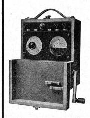
Appareil pour la mesure des prises de terre.
