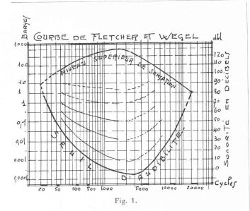
c'est-à-dire les pressions les plus faibles à partir desquelles l'oreille commence à être impressionnée. La courbe supérieure, au contraire, est celle du niveau supérieur d'audibilité, c'est-à-dire celui à partir duquel l'audition devient douloureuse. L'espace compris entre les deux courbes mesure donc l'ensemble des phénomènes acous-
