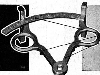
Cet instrument de mesure se compose de 2 pièces en **Fonte injectée** qui peuvent être montées sans usinage. L'échelle est coulée directement.
