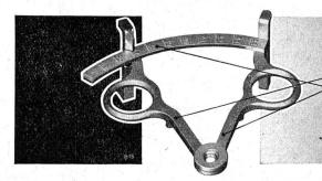
Cet instrument de mesurage se compose de 2 pièces en Fonte injectée qui peuvent être montées sans usinage. L'échelle est coulée directement.
