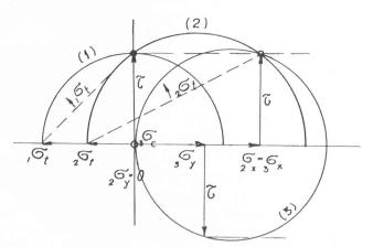
Fig. 6. - Modération des tensions obliques par la précontrainte.
