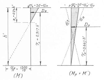
Fig. 5. — Diagrammes de Navier sans ou avec précontrainte.
