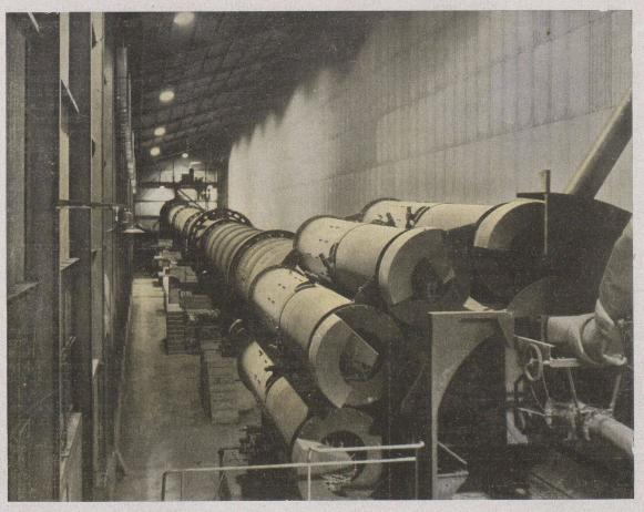
Four rotatif d'une sabrique de ciment, éclairé par des lampes Osram à vapeur de sodium (lumière monochromatique jaune).
