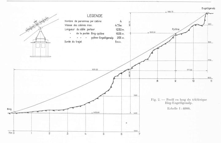
1025 m. La vitesse étant de 4 m : s. l'installation permet de transporter 28 personnes par heure, dans un sens et autant dans l'autre sens.
