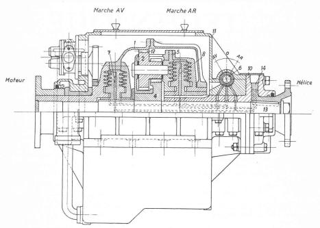
Fig. 8. — Coupe schématique à travers un inverseur de marche type MWP  $^{\alpha}$  S. L. M. Winterthur ».
