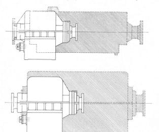
Fig. 13 et 14. — Comparaison entre des inverseurs de marche type MWP — S. L. M. — Winterthur et des appareils inverseurs de même puissance de construction courante.
