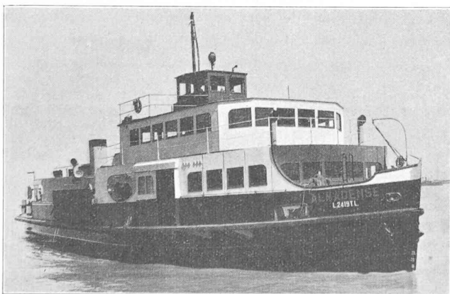
Fig. 3. — Bac portugais muni d'une installation motrice complète « S. L. M. — W. » comprenant un moteur Diesel de propulsion, de 425 ch, avec inverseur de marche type MWP.
