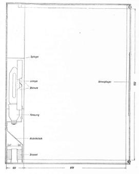
Fig. 2. Coupe longitudinale d'un transparent à double face éclairante.
