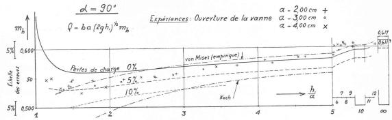
Fig. 19. — α = 75° — 90°. (Voir légende sur figure 17.) Voir, figure 16, perte de charge observées.
