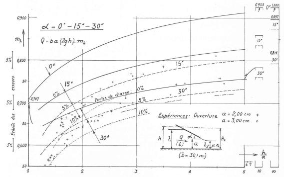
Fig. 17. —  $\alpha=0^{\circ}$  — 15° — 30°. Coefficients de débit  $m_h$  donnés en fonction du rapport  $\frac{h_1}{a}$ . Résultats du calcul hydrodynamique et des expériences ( $m_h$  est déduit de la mesure de  $h_1$  et du débit déterminé par jaugeage). Pour  $\alpha=30^{\circ}$ , voir pertes de charge sur la figure 14.
