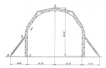
Fig. 3. — Coupe transversale. a-b= contre-fiche ; c-d= paroi ; d-e= demi-ferme.  $a,\ b,\ c,\ d$  et e= articulations.
