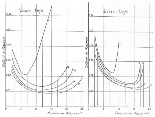
Fig. 2. Coefficient de frottement, fonte sur fonte, en fonction de la pression, à une température de 800 C.
