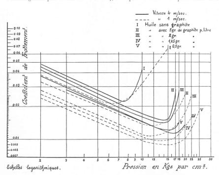
Fig. 1. — Coefficient de frottement, fonte sur fonte, en fonction de la pression, à une température de 800 C. (Coordonnées logarithmiques).
