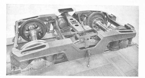
Fig. 7. — Bogie moteur.
