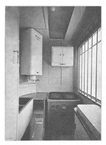
Fig. 6. — Cuisine électrique de la voiture-buffet. Armoire chauffante, chauffe-eau « Therma », cuisinière spéciale « Therma ».
