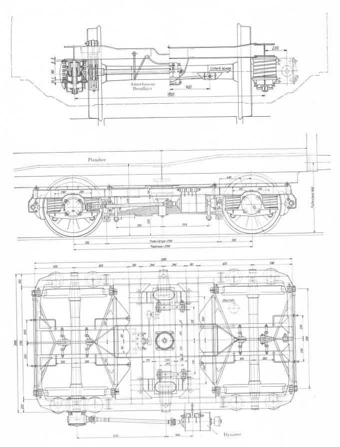
Fig. 8. — Bogie des voitures légères en acier, des C. F. F.
