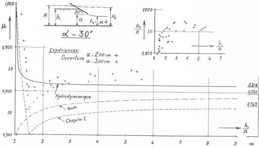
Fig. 14. —  $\alpha$ =30°. Coefficients de contraction  $\mu$  mesurés et calculés en fonction du niveau amont. Rapport des charges aval et amont  $\frac{H_2}{H}$ .
