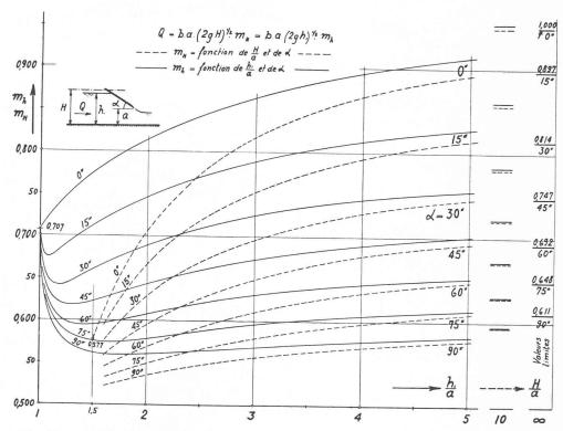
Fig. 11. — Coefficients de débit  $m_H$  et  $m_h$  en fonction de la charge H et du niveau amont  $h_1$ . (Déduits de la contraction calculée par la méthode hydrodynamique.)
