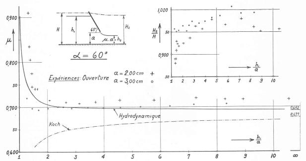
Fig. 15. —  $\alpha$  = 60°. Coefficients de contraction  $\mu$  mesurés et calculés en fonction du niveau amont. Rapport des charges aval et amont  $\frac{H_2}{H}$ .
