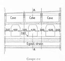
Fig. 2. — Coupes en long, en travers et en plan dans le tunnel et le garage.
