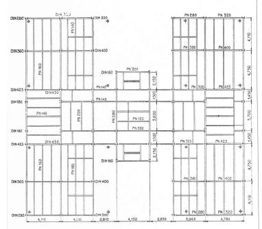
Fig. 8. — Poutrellage au niveau 3,25 m.
