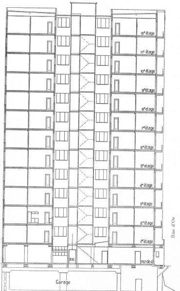
Fig. 7. — Coupe transversale dans l'axe du bâtiment.
