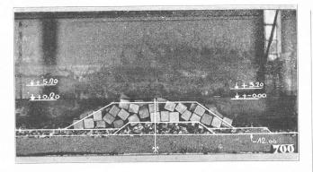
Effet d'une tempête de 12 heures sur l'ouvrage défini sur la base des résultats des essais et tel que donné à la figure 17. Hauteur des vagues  $2h=9{,}00~{\rm m}$  ; longueur  $2L=220~{\rm m}$ . Cote de la mer au repos : + 0,20 m.
