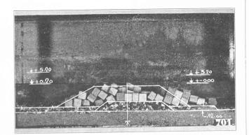
Fig. 19. — Effet d'une tempête de 12 heures sur l'ouvrage défini sur la base des résultats des essais (fig. 47). Hauteur des vagues :  $2h = {\rm environ} \ 12,00 \ {\rm m}$ ; longueur :  $2L = 220 \ {\rm m}$ . Cote de la mer au repos: 0,20 m.
