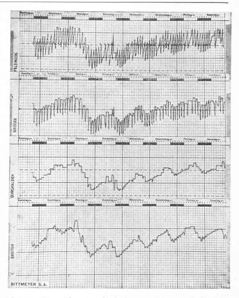
Fig. 3. — Un graphique de solidarisation, par télécommande Rittmeyer, des 4 réservoirs superposés du Service des eaux de Richterswil.
