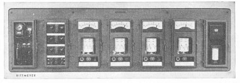
Fig. 4. — Station, système *Rittmeyer*, de r'ception de signaux et de télécommande de la distribution d'eau de Mannedorf.
