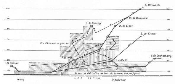
Fig. 2. — Profil en long schématique avant la rénovation de l'amenée des eaux des Avants.
