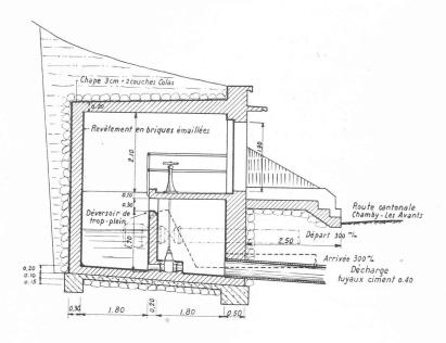
Fig. 11. — Chambre de Sollard. Echelle 1:100.
