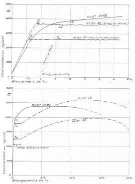
Fig. 1 et 2. — Caractéristiques de traction de divers aciers.
