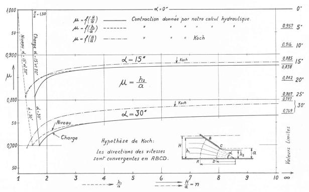
Fig. 4. — Coefficients de contraction μ donnés en fonction de la charge et du niveau amont.
