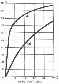
Fig. 2. — Rendement en fontion du degré d'utilisation, de 2 types de chauffe-eau.
