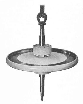
Fig. 1. — Roue centrifuge B.B.C., à grande vitesse.
