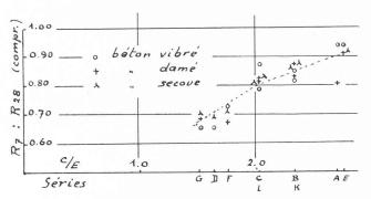
Fig. 3. — Intensité du durcissement entre 7 et 28 jours, en fonction du rapport C:E.
