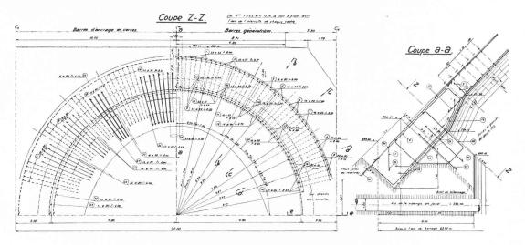
Fig. 15. — Plan d'armature de la base de la voûte (encastrement dans le parafouille). La coupe a-a est une coupe à la clé.
