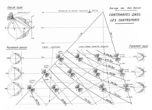
Fig. 11. — Contraintes dans le contrefort. Les secteurs hachurés indiquent les directions suivant lesquelles le cisaillement effectif n'est pas nul.
