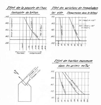
Fig. 14. — Contraintes à la clé dans la section d'encastrement de la base des voûtes, en fonction de la position de cet encastrement.
