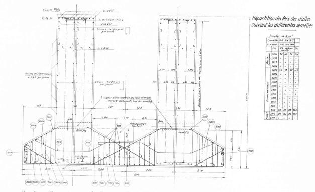
Fig. 9. — Coupe transversale d'une semelle de fondation aval. La pression transmise au sol est de 50 t/m².
