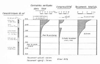
Fig. 8. — Schéma du calcul des tassements dans le cas d'une surcharge circulaire de 60 cm de diamètre et d'une pression de 20 kg/cm²
