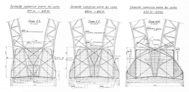
Fig. 17. — Coupe des semelles des voûtes. La semelle repose sur le contrefort sans armature de liaison.
