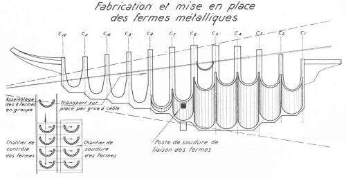
Fig. 18. — Mise en place du béton. Fabrication des fermes métalliques.
