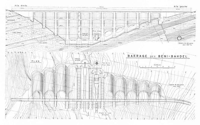
Fig. 5. — Elévation aval et plan du barrage des Beni-Bahdel.
