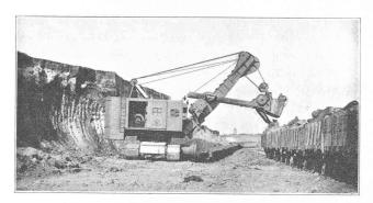
Fig. 1. — Pelle Menck et Hambrock, modèle « Md » de 1,9 m³ de contenance, équipée électriquement.
