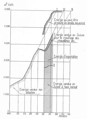
Fig. 1. — Energie électrique qu'il est possible de produire en Suisse, en année moyenne, livrée à des tiers.
