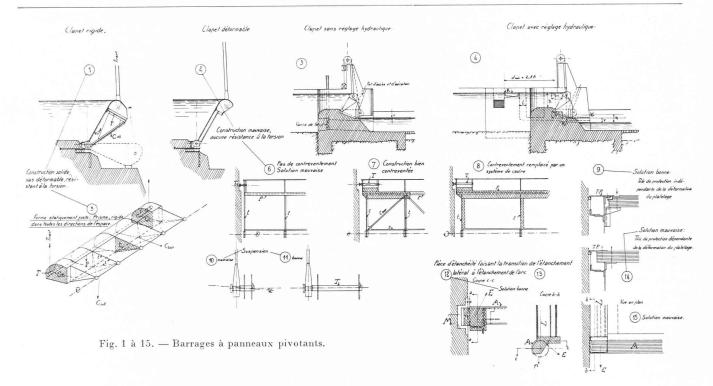
plus d'une fois. Il est compréhensible que cette manière d'appuyer le tourillon provoque une inclinaison sensible de l'axe du tourillon et, par suite, des coincements au palier de la suspension et une flexion dans le tirant.
