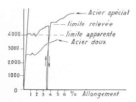
Fig. 4. — Diagrammes de déformation d'aciers doux et mi-durs.
