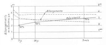
Fig. 3. — Diagrammes de prise des ciments à expansion.
