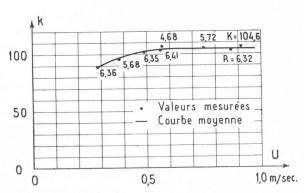
Fig. 5. — Représentation graphique du coefficient de la formule de Strickler k en fonction de la vitesse U.
