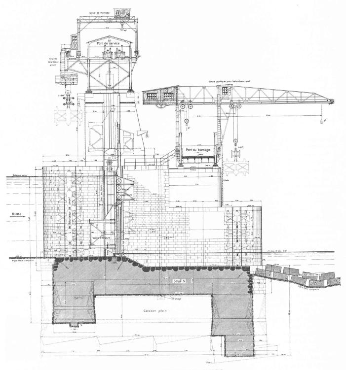
Fig. 2. — LE BARRAGE DE KEMBS Coupe transversale du seuil et vue latérale d'une pile. — Echelle 1 : 250.
