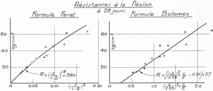
Fig. 1. — Résistance à la compression et à la flexion de bétons à divers dosages et ballasts. — Consistance pâteuse.
