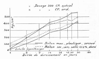
Fig. 7. — Influence de la consistance du béton et de sa plasticité sur le durcissement.
