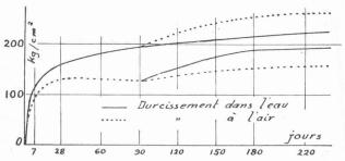
Fig, 6. — Influence de l'humidité du béton sur son durcissement. Dosage 270 CP par m³ de béton. C: E = 1,35.
