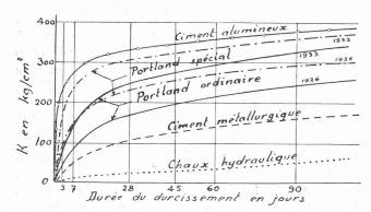
Fig. 1. — Valeurs de K en fonction de la durée de durcissement, pour la formule de résistance R = K (C: E - 0.50).
