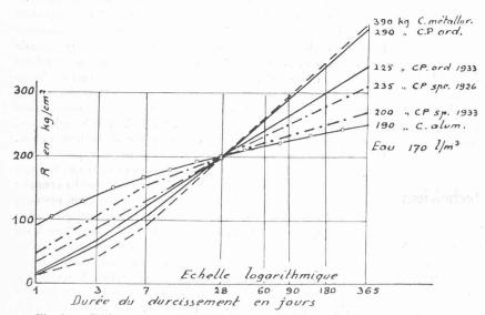
Fig. 4. — Résistance, entre 1 et 365 jours, de bétons ayant la même résistance, de 200 kg/cm², à 28 jours et fabriqués avec divers ciments.
