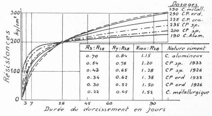
Fig. 3. — Résistances, entre 1 et 100 jours, de bétons ayant la même résistance, de 200 kg/cm², à 28 jours et fabriqués avec divers ciments. (Eau 170 l :  $m^3$ ).
