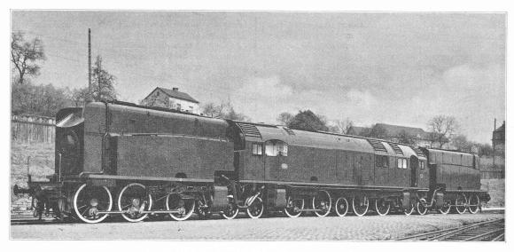
Fig. 2. — Locomotive Franco de 3000 ch. (Ateliers métallurgiques de Nivelles.)
