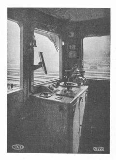
Fig. 3. — Poste de commande de l'automotrice Diesel-Sulzer du « Ferrocarril Provincial » de Buenos-Aires.
