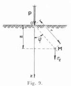
ν est un paramètre dont la valeur dépend des caractéristiques du matériau <sup>1</sup>. En général, les valeurs à adopter pour ν seront comprises entre 3 et 6. Les résultats des essais géotechniques, la position relative des couches rigides ou molles, le mode de transmission de la charge sont les éléments principaux permettant de fixer la valeur de ce paramètre <sup>2</sup>.
