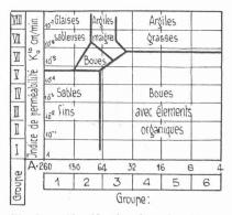
Fig. 8. — Classification des sols sableux argileux proposée par M. Terzaghi. Elle est basée sur les résultats de l'essai ædométrique.
