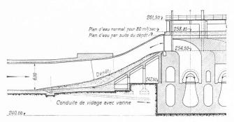
Fig. 2. — Usine de Pont-de-Claix. Coupe en long de l'extrémité aval de la conduite forcée, avec la conduite de vidage, la rampe et deux chambres de turbines.
