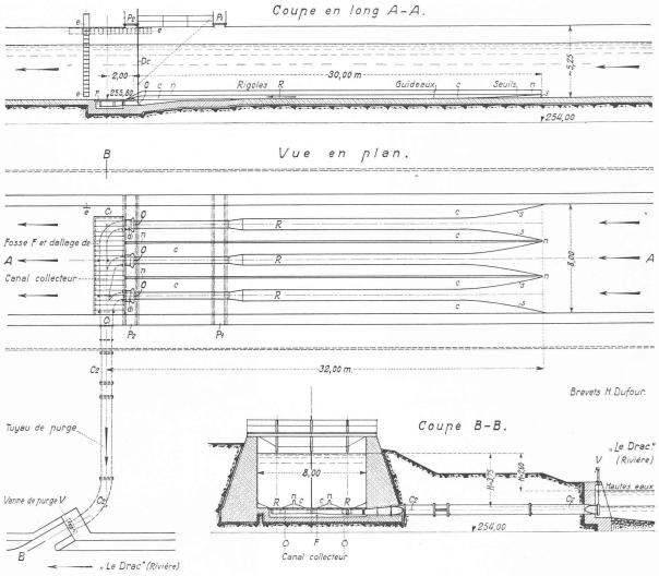
Fig. 4. — Dessableur Dufour Type III du canal de l'usine de Pont-de-Claix, pour 80 m³: s, avec dispositif pour le contrôle des orifices pendant l'exploitation.
