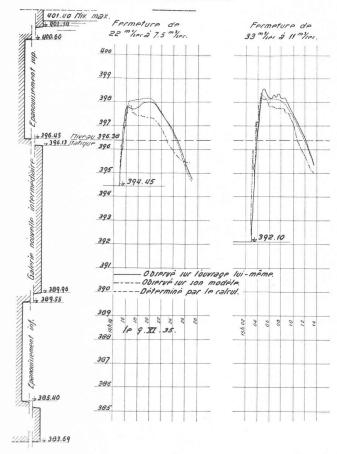
Fig. 17. — Diagramme comparatif des oscillations obtenues en réalité au modèle et par le calcul dans le cas de deux fermetures partielles.
